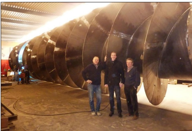
Bron: De Vlaamse Waterweg nv. Afmetingen van de Archimedes schroeven in de installaties: L: 28m, diameter: 4.3m, gewicht: 85ton, capaciteit: 3 à 5 m 3 /s.
